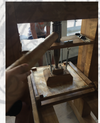
In der Druckerwerkstatt: Papier wird passend eingelegt. Die Druckform eingefärbt und geschlossen. Der Schlitten unter den Druckblock geschoben und mit dem Hebel gepresst.
