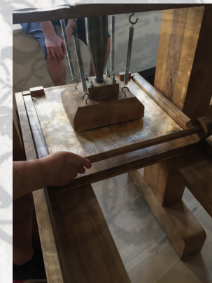
In der Druckerwerkstatt: Papier wird passend eingelegt. Die Druckform eingefärbt und geschlossen. Der Schlitten unter den Druckblock geschoben und mit dem Hebel gepresst.
